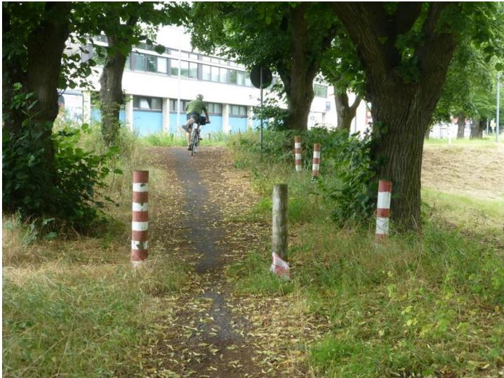
Auch hier, beim Ausgang der Allee zur Schweinfurter-Straße verengen die Pfosten die Durchfahrt unnötig. Bei Dämmerlicht und Dunkelheit ist der mittlere Pfosten zudem gar nicht zu erkennen. Er sollte entfernt werden.
